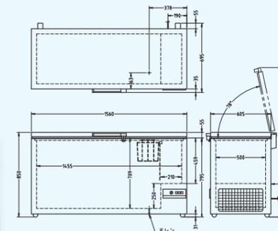
\*\*\* 外形寸法：1560 x 695 x 850mm / 庫内寸法：1455 x 500 x 709mm
