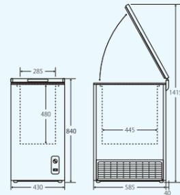
\*\*\* 外形寸法：430 x 625 x 840mm / 庫内寸法：285 x 445 x 480mm
