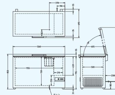
\*\*\* 外形寸法：1260 x 695 x 850mm / 庫内寸法：1155 x 500 x 709mm
