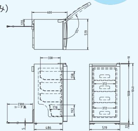
\*\*\* 外形寸法：519×600×1040mm / 庫内寸法：372×338×846mm
