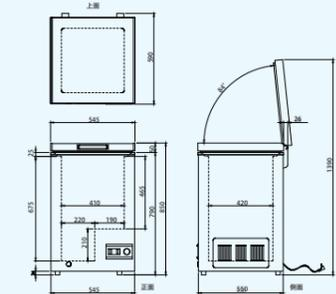
\*\*\* 外形寸法：545 x 590 x 850mm / 庫内寸法：410 x 420 x 675mm
