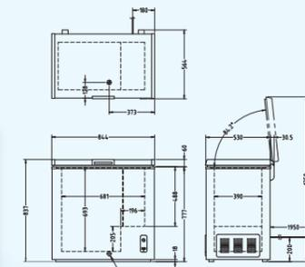
\*\*\* 外形寸法：844 x 564 x 837mm / 庫内寸法：681 x 390 x 693mm
