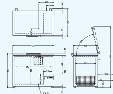
\*\*\* 外形寸法：1020 x 695 x 850mm / 庫内寸法：915 x 500 x 709mm
